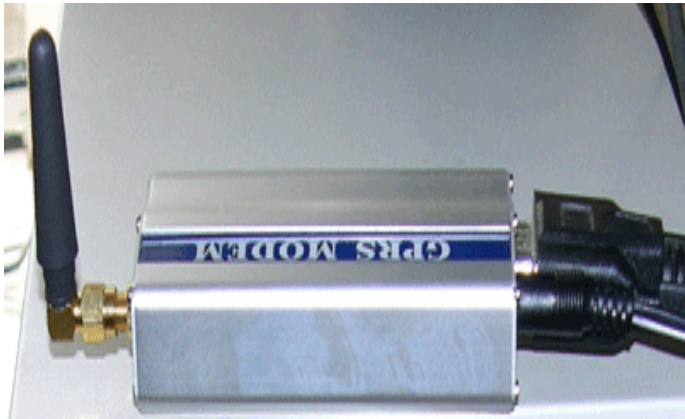
将数据线与GSM modem硬件设备连接
